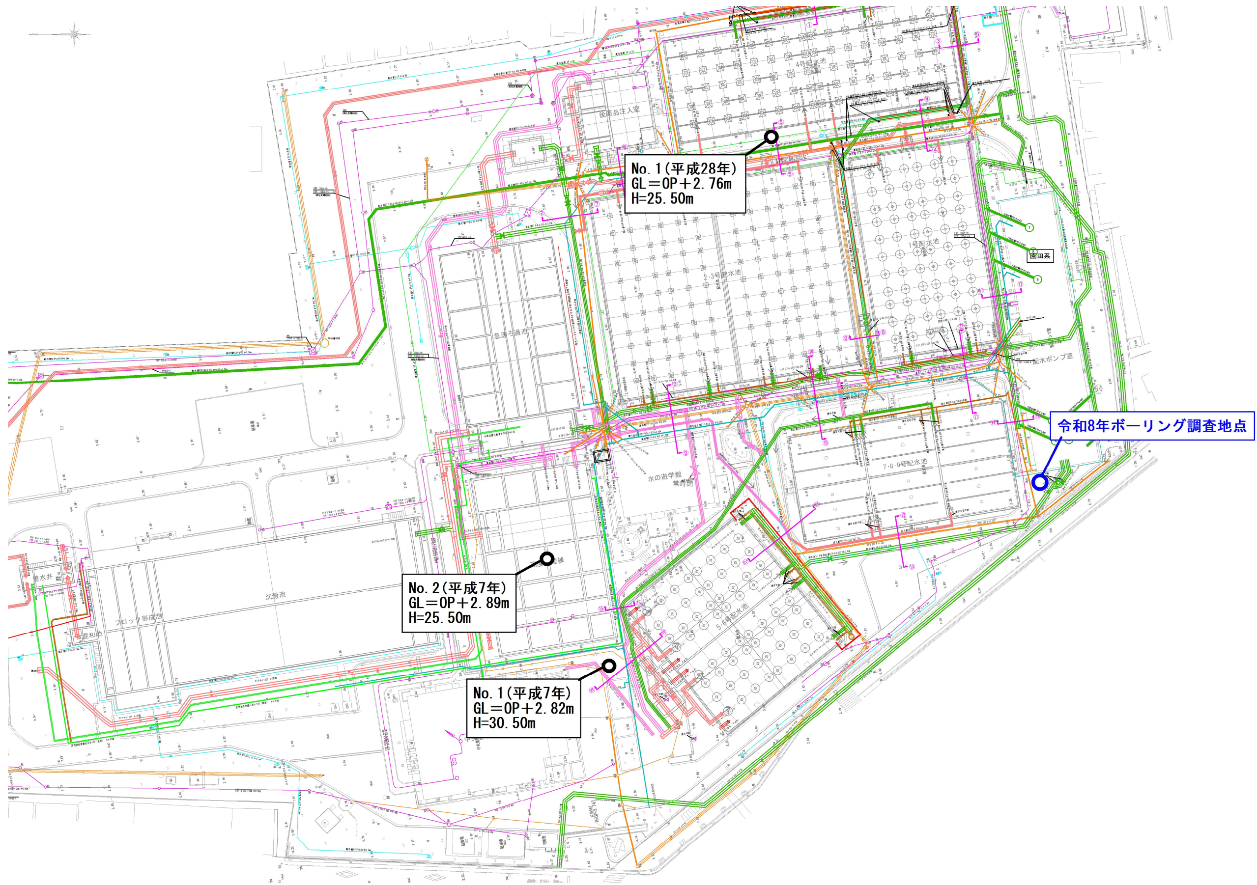
図 4.1 ボーリング調査地点
