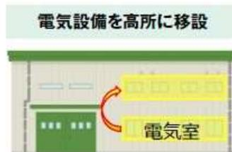
高所に移設することで、設備が水没することを防ぎ、設備の機能を確保します。
