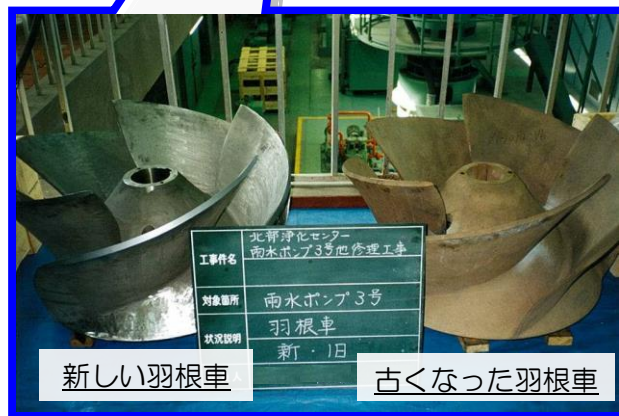
写真3 部品交換により耐用年数を超えて利用している既存設備の現場写真
