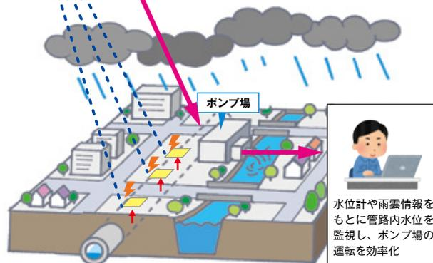
水位計や雨雲情報をもとに管路内水位を監視し、ポンプ場の運転を効率化
