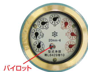
口径20ミリメートルの アナログ式水道メーター
